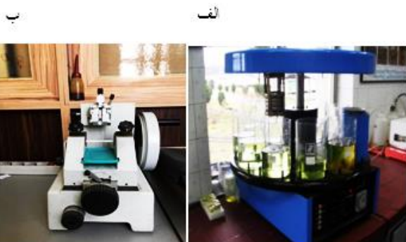
شکل ۳: الف: دستگاه عمل آوری بافت (مراحل شستشو، آبگیری و شفاف‌سازی بافت‌ها) ب: دستگاه میکروتوم (Leitz, 1512) جهت تهیه اسلایدهای بافتی
